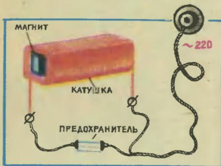
Обмотайте магнит слоем изоляционной ленты. На нем виток к витку уложите 300—350 витков провода ПЭЛ-1,0. Чтобы витки не сползали, сверху закрепите их также изоляционной лентой. Через проволочный предохранитель (диаметр проволоочки 0,1 мм) подключите катушку к сети напряжением 220 В, как показано на рисунке.
